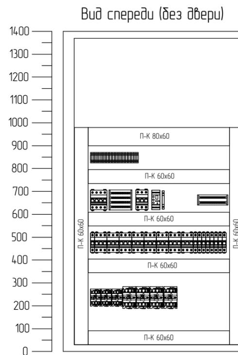
Компоновка устанавливаемого оборудования может отличаться от представленного варианта. На внешнем виде представлены основные комплектующие и возможный способ их размещения.
