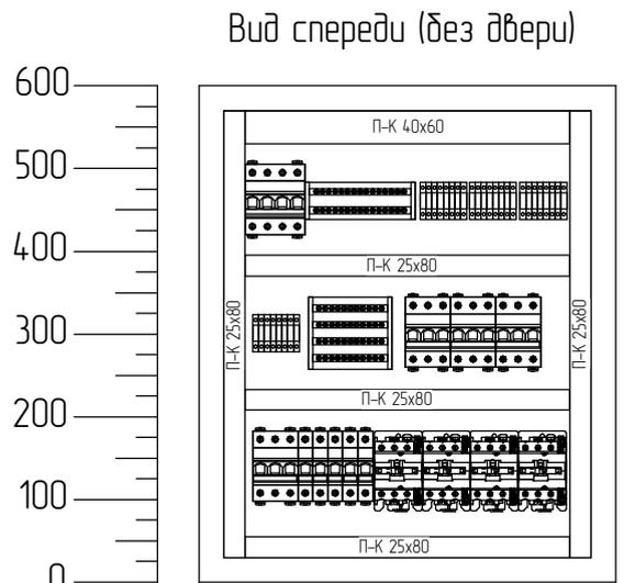
Компоновка устанавливаемого оборудования может отличаться от представленного варианта. На внешнем виде представлены основные комплектующие и возможный способ их размещения.
